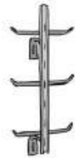
*Escala fija de un montante*
