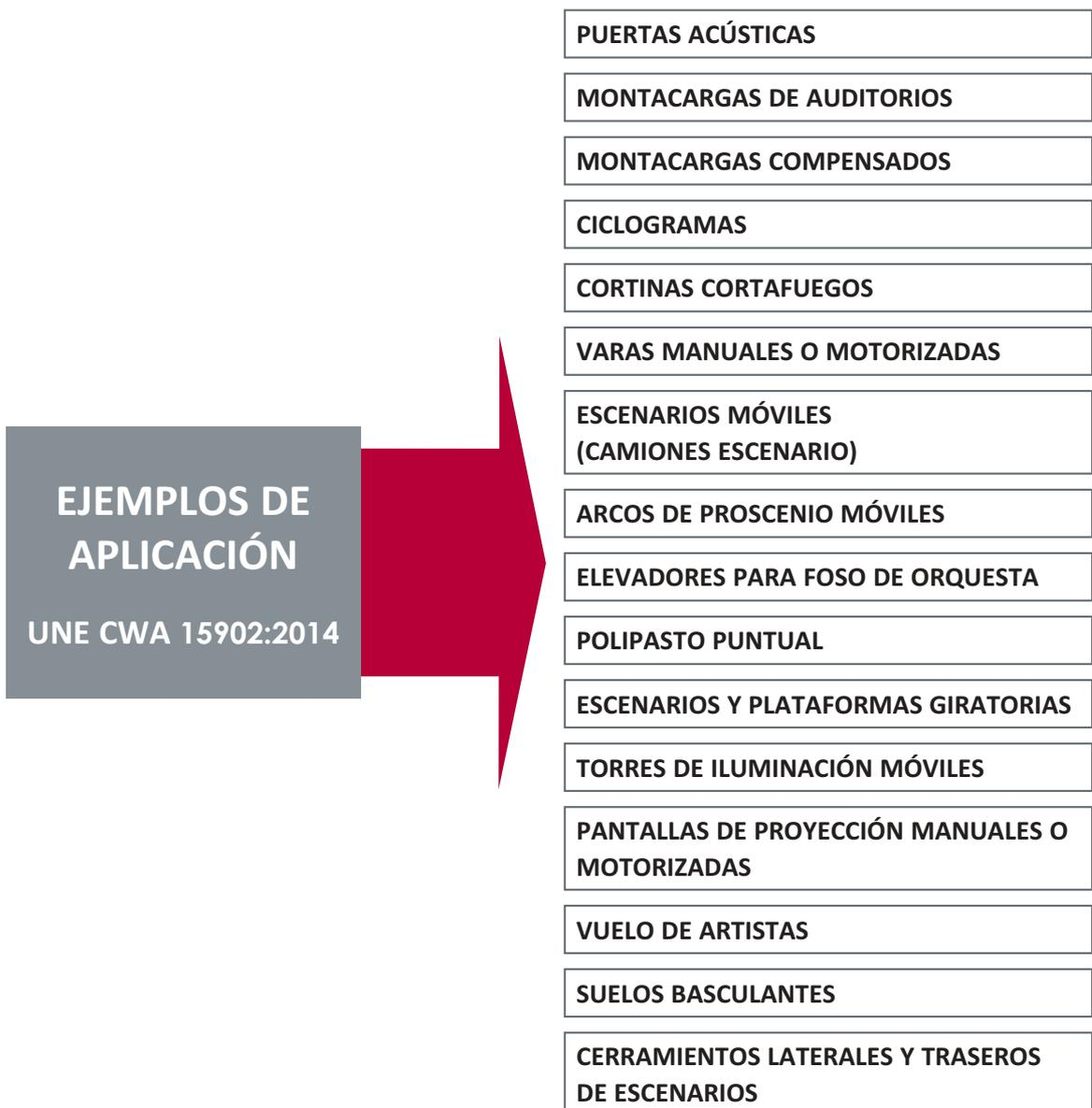
\* La norma UNE-CWA 15902-1:2014. Equipos de elevación y suspensión de cargas en escenarios y otras áreas de producción dentro de la industria del entretenimiento, tiene aplicación sobre la maquinaria e instalaciones de maquinaria con equipos de suspensión y movimiento de cargas guiado o sin guiar.
